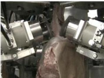
図10. 食肉加工用搭載水圧ベーンモータ
